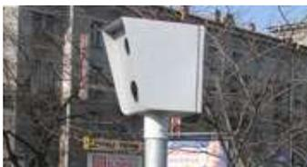
2. **АРЕНА-2** устанавливается в бокс сбоку от края дороги на расстоянии 3-5 метров под углом 25 градусов к дороге, фиксирует:
