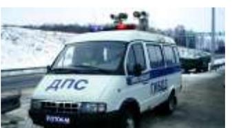
10. **Поток-М** обеспечивает считывание номерных знаков, их проверку, визуальное и звуковое оповещение оператора о выявлении совпадения с БД
