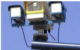
1. **АРЕНА** устанавливается над полосой движения, на мосту, ферме или др. конструкциях на высоте 4-8 метров от дороги, фиксирует:
