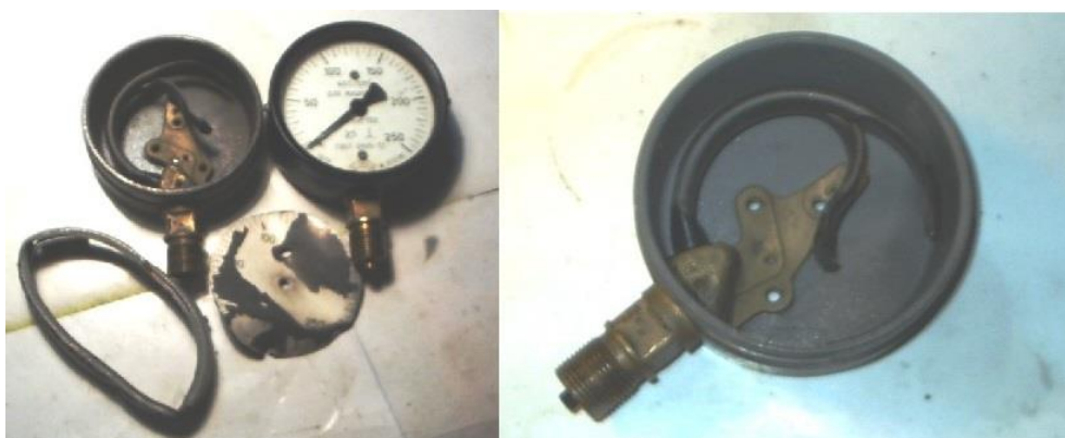
Пример воспламенившегося манометра, установленного на кислородную магистраль
