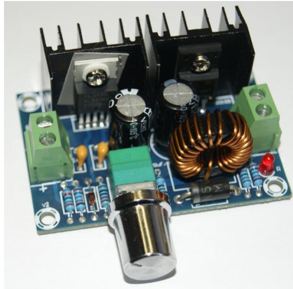
Рис. 1.10 Макет понижающего DC-DC преобразователя напряжения.
