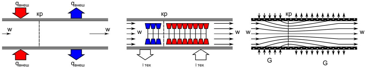
Так сверхзвуковой поток может быть получен в так называемом **тепловом сопле** – канале постоянного поперечного сечения  $dF=0$  при  $l_{\text{тех}}=0$ ,  $l_{\text{тр}}=0$ ,  $dz=0$ . В этом случае поток ускоряется за счет подвода или отвода теплоты через стенки канала:
