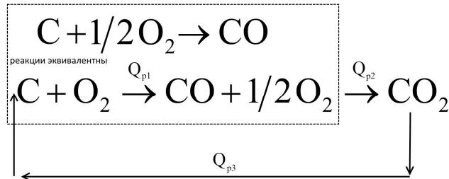
В соответствии с законом Гесса  $-Q_{p1} + -Q_{p2} + +Q_{p3} = 0$ , откуда искомый тепловой эффект реакции определяется следующим образом:
