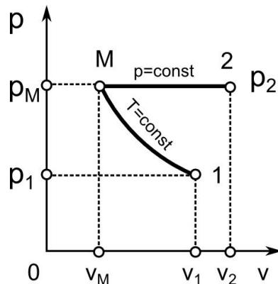
Сжатие газа в изотермическом процессе 1-М описывается уравнением закона Бойля – Мариотта:
