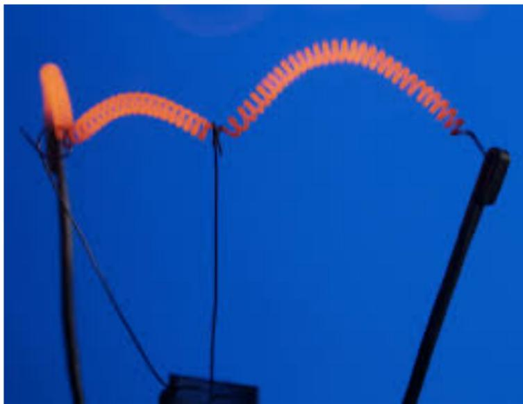
Поэтому нить накаливания электролампы, изготовленная из вольфрама имеет много большее сопротивление, чем подводящие медные или алюминиевые провода, которые при этом практически не нагреваются.
