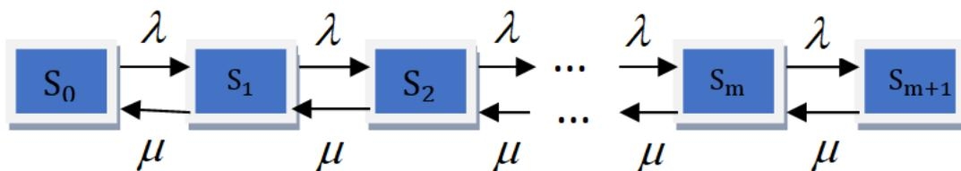
Рис.1. Граф состояний одноканальной СМО с очередью
