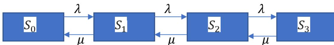
Рис.1. Граф состояний одноканальной СМО с очередью длиной 2.
