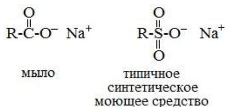
Рисунок 10. Различие в строении мыла СМС
