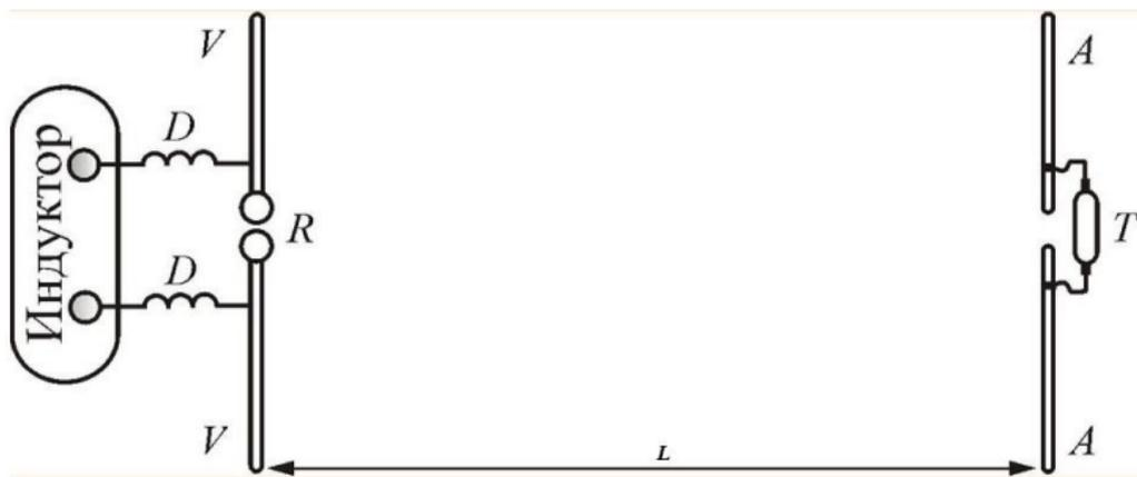
Излучение вибратора Герц регистрировал с помощью второго вибратора, имеющего такую же резонансную частоту, что и излучающий вибратор, поэтому второй вибратор называется **резонатором**.
