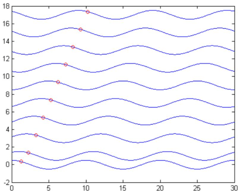
Снизу вверх:  $t_n = nT/10$ ,  $n = 0, 1, \dots, 9$ , ось абсцисс - ось  $x$ , ось ординат - напряженности полей в произвольных единицах. Кружок отмечает значение фазы волны равной  $\omega t - kx = -\pi/4$ .
