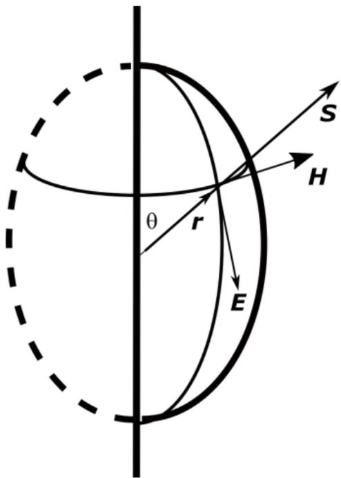
В волновой зоне структура поля упрощается по сравнению с полем в ближней зоне и амплитуды поля спадают с расстоянием как
