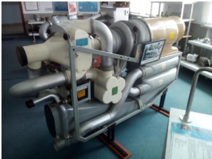
Рис. 5. Общий вид блока охлаждения СКВ Ту-204
