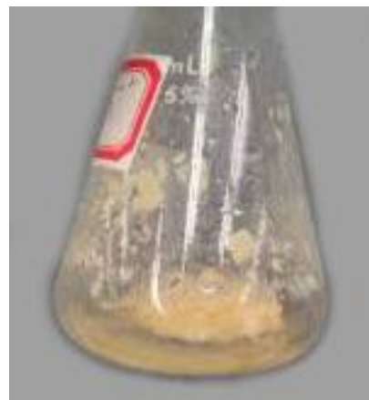
Рисунок 22. Реакционная смесь бензальдегида в гидроксиде натрия (реакция Канницаро)
