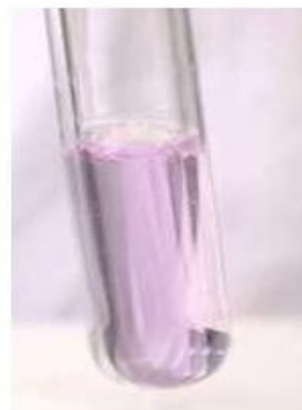
Рисунок 24. Окраска раствора смеси формальдегида с фуксинсернистой кислотой
