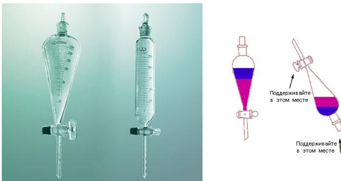
Рисунок 9. Виды делительных воронок и пример разделения двух несмешивающихся жидкостей в делительной воронке.
