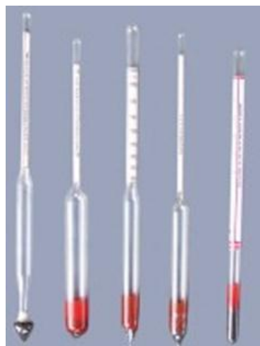
Рисунок 1. Пикнометры и ареометры, используемые для измерения плотности растворов.
