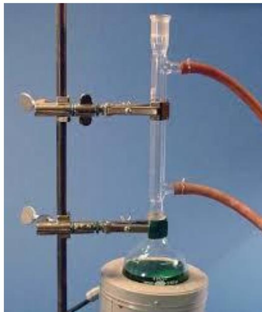
**Рисунок 1.** Прибор для очистки бензойной кислоты.
