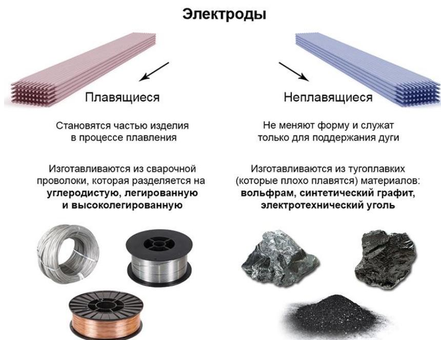
Первую из них чаще используют для работ с материалами толщинами от 0,1 мм, а вторую – при соединении заготовок от 2 мм и толще.
