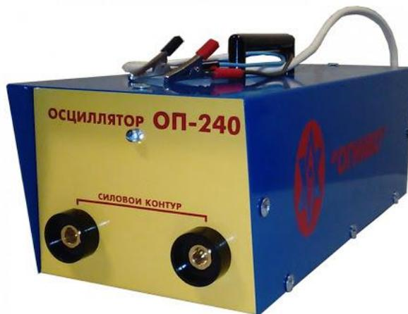
**Высоковольтные импульсы**, насыщая ионами промежуток дуги, способствуют возбуждению дуги с пуском тока.
