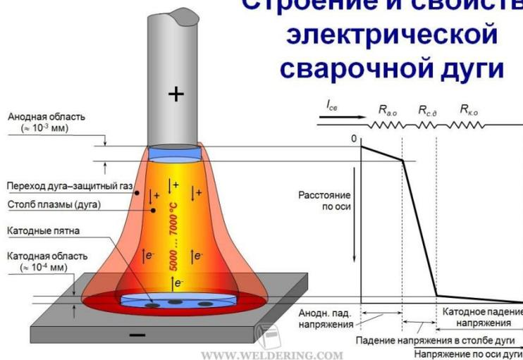
Сварочной дугой называют мощный, длительно существующий электрический разряд между находящимися под напряжением электродами в смеси газов и паров. Дуга характеризуется высокой температурой и большой плотностью тока.
