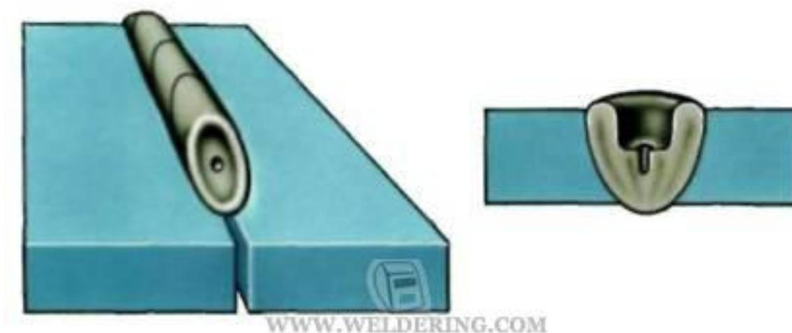
**Усадочная раковина**, расположенная в конце валика и не **заваренная** при последующих проходах, образует **кратер**.
