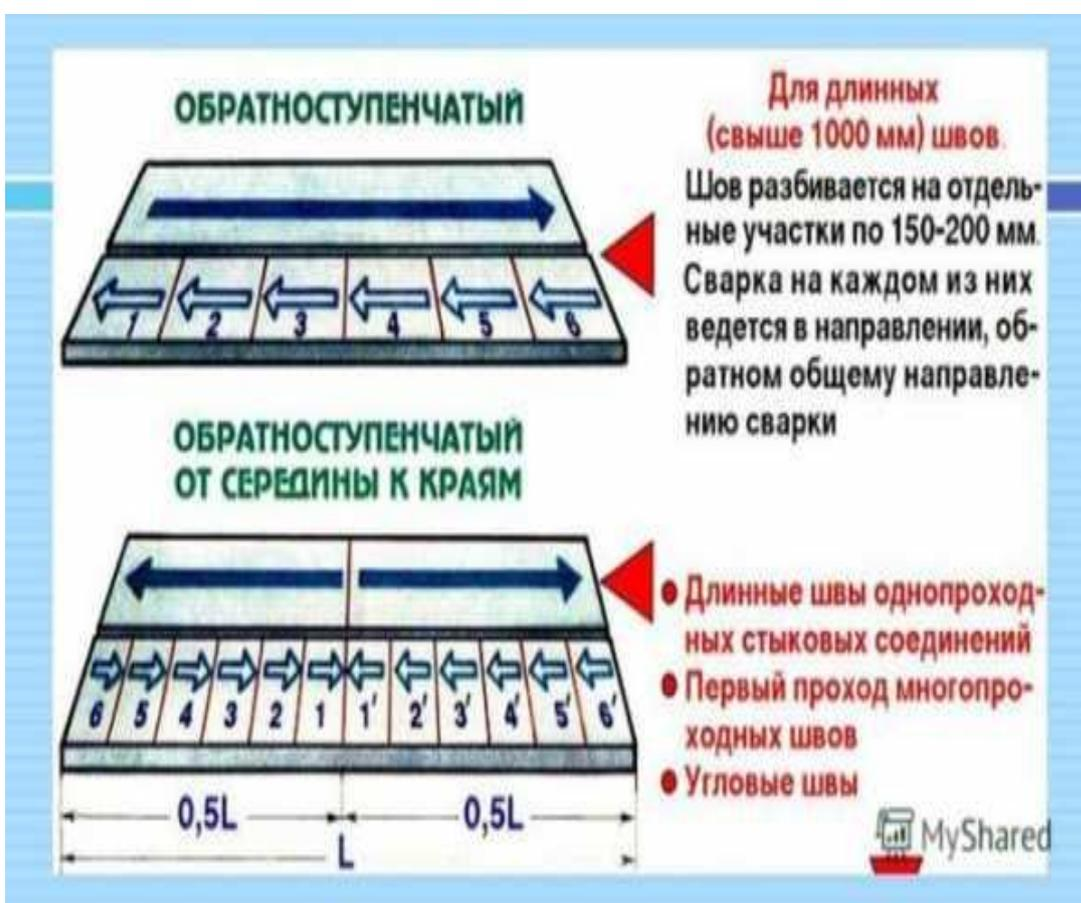
При сварке *обратноступенчатым* способом многослойных швов концы участков (ступеней) в смежных слоях не должны совпадать, и их необходимо сдвигать на 15—20 мм, это делают потому, что в точках начала и конца швов наиболее вероятно появление дефектов (непроваров, шлаковых включений)
