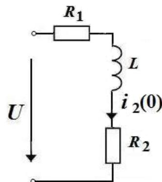
Из схемы после коммутации, при  $t = 0$ , определяем зависимые начальные условия.
