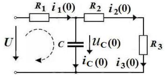
ключа К, резисторы  $R_2$  и  $R_3$  образуют ветвь последовательно соединенных элементов, и эта ветвь включена параллельно емкости С, поэтому:
