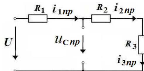
Зависимые начальные условия определяем по схеме цепи после коммутации, с учетом независимого начального условия. После размыкания
