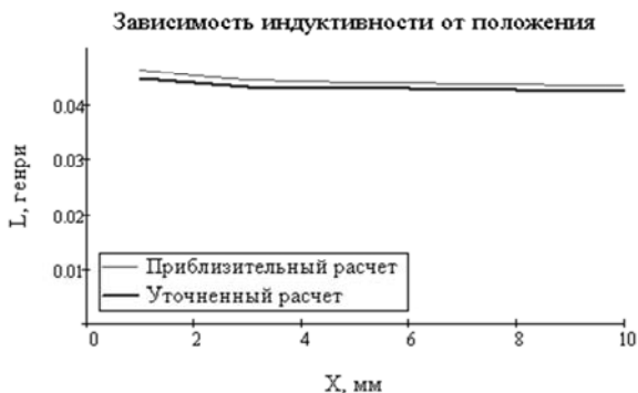
Рис. 71. Изменение индуктивности от положения груза
