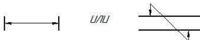
Рисунок 8.1 – Условное обозначение звена
