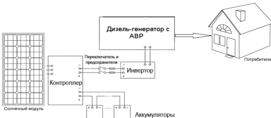
Рисунок 1 – Структурная схема автономной системы электроснабжения
