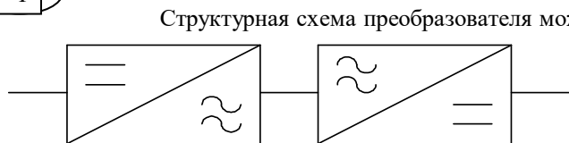
Рис. 7. Преобразователь постоянно-постоянного тока со звеном переменного тока
