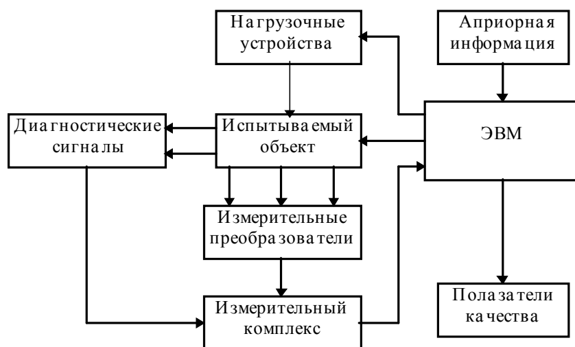
Рис.1. Структура испытательно- диагностического комплекса
