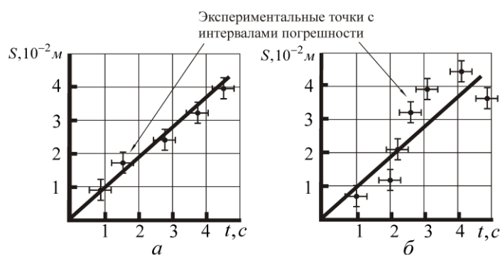
Рис. 1. Аппроксимация экспериментальных точек: а – правильная аппроксимация экспериментальных точек (прямая проведена в пределах погрешности симметрично относительно точек); б – неверная аппроксимация экспериментальных точек (линия не пересекает интервалы погрешности)
