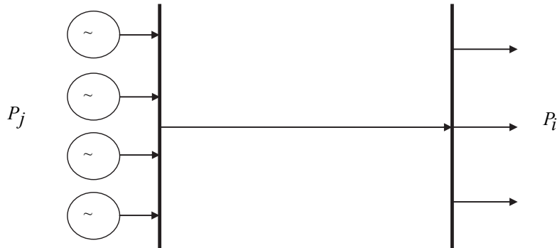
Рис. 3.1. Структурная схема баланса мощности. Модель 1
