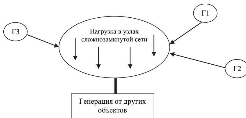
Рис. 4.3. Схема адресного распределения для узлов генерации
