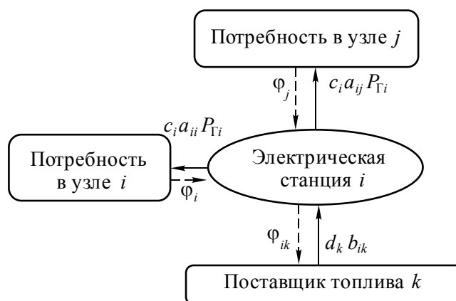
Рис. 8.1. Схематическое представление финансового баланса i -й станции
