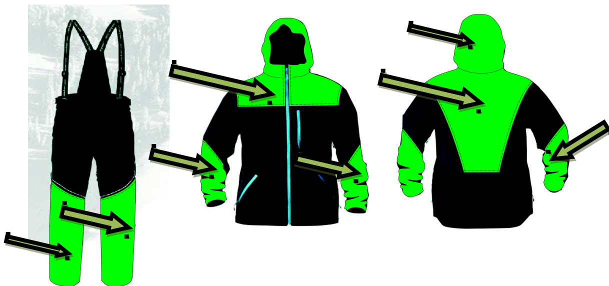
Рис. 4.30. Ветрозащитный костюм для космонавтов, предназначенный для аварийной посадки в зимнее время ( )утепляющие конструктивные элементы.
