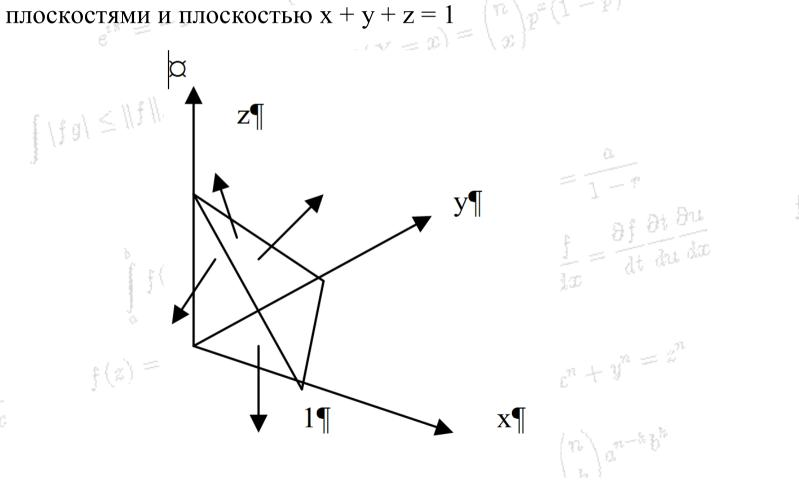
· 京·立85 = 111 [\fg\ ≤\\! Поток радиус-вектора через координатные плоскости нулевой, так как на них радиус-вектор точки лежит в координатной плоскости и ортогонален нормали к координатной плоскости, т.е.  $\vec{a} \cdot \vec{n} = 0$ .
