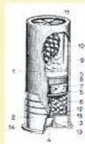
1 - трубка гильзы, 2 - основание гильзы, 3 - поддон, 4 - капсуль-воспламенитель, 5 - прокладка, 6 - метательный заряд, 7 - осалка на пыже, 8 - пыж, 9 - полимерный пыж с концентратором, 10 - дробовой снаряд, 11 - закатка "звезда", 12 - запальное отверстие, 13 - наковальня, 14 - фланец, 15 - пороховая камера
