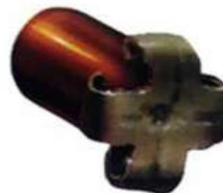
X-bullet: цельномедная пуля, в носовой части — экспансивная полость с надрезами, по которым она «раскрывается» после попадания в цель
