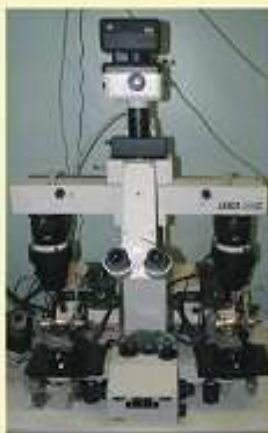
микрофотосъемка с использованием сравнительного микроскопа
