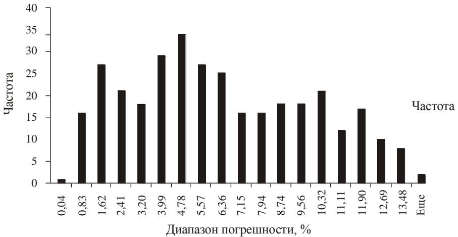
Рис. 8.7. Частота появления погрешностей после внесения поправки на температуру
