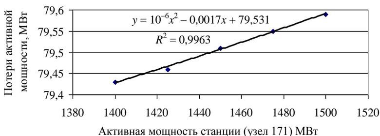
Рис. 11.12. Характеристика потерь активной мощности для узла
