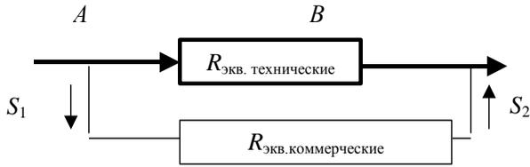
Рис. 11.13. Схема расчета потерь мощности по эквивалентным и активным сопротивлениям
