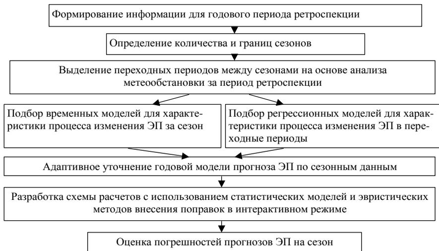
Рис. 5.7. Схема расчетов прогноза сезонного электропотребления
