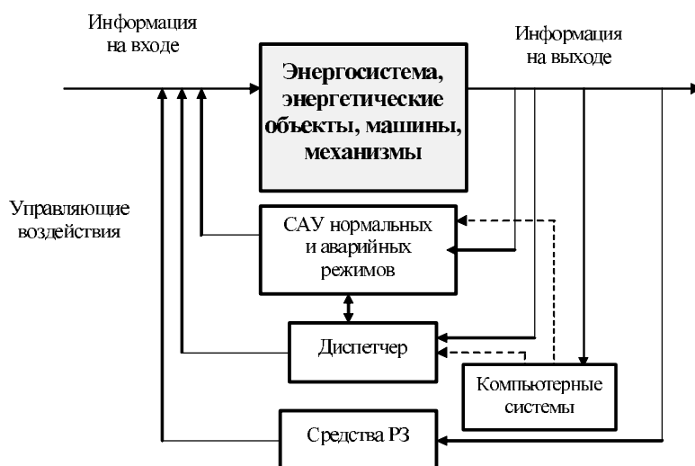
Рис. 1.7. Схема средств и систем оперативного управления энергетическими системами и объектами
