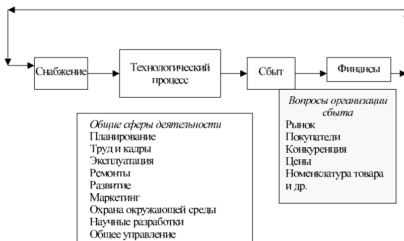
Рис. 1.3. Схема производственного процесса в энергетике
