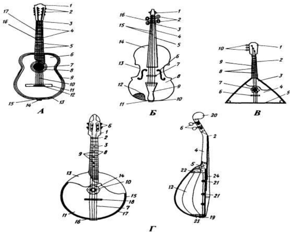
**А. Гитара:** 1 - головка; 2 - колковый механизм; 3 - порожек; 4 - лад; 5 - точки; 6 - резонансовая дека; 7 - резонаторное отверстие; 8 - розетка; 9 - обкладка (штамп); 10 - струна; 11 - подставка; 12 - порожек (лад) подставки; 13 - жилка; 14 - кнопка; 15 - стрелка; 16 - ручка; 17 - наклейка
