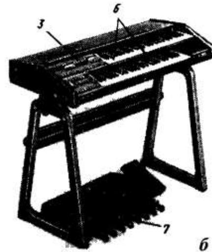
**Электросинтезатор:** а - программируемый цифровой, б - трехмануальный цифровой; 1 - ручки управления; 2 - форманты; 3 - дисплей; 4 - кнопки выбора программ; 5 - наборное поле для программирования; 6 - клавиатура; 7 - ножная клавиатура
