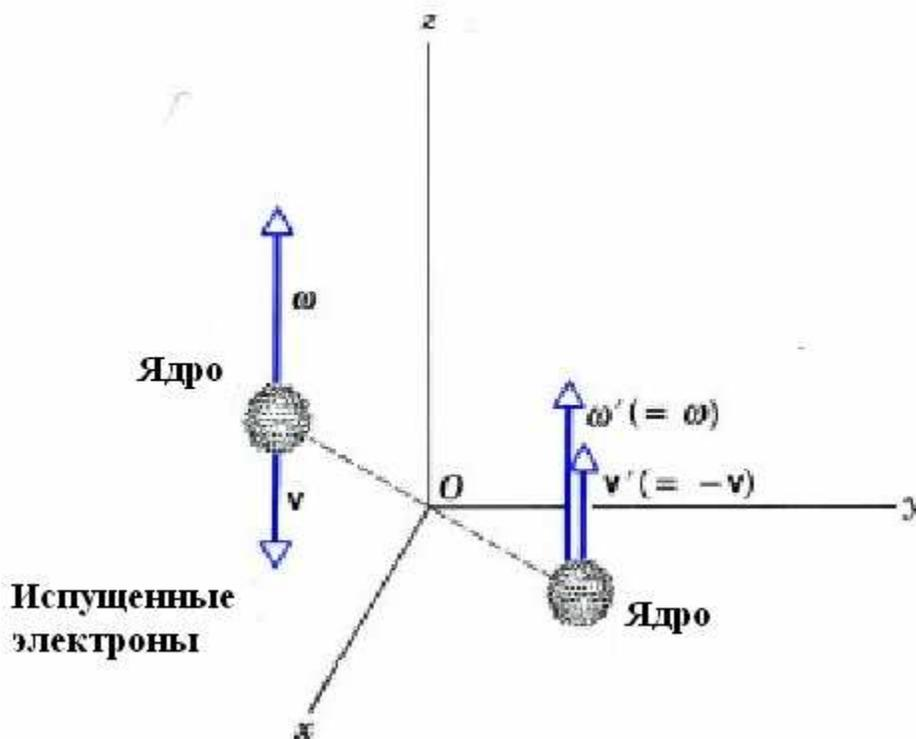
Рис. 20. Ядра, вращение которых характеризуется вектором угловой скорости  $\omega$ , испускают электроны преимущественно в направлении противоположном  $\omega$ . В зеркально отраженной версии этого эксперимента электроны должны испускаться в основном вдоль вектора  $\omega'$ . Эксперимент и его отраженный вариант не идентичны друг другу, что означает нарушение зеркальной симметрии при этих распадах.
