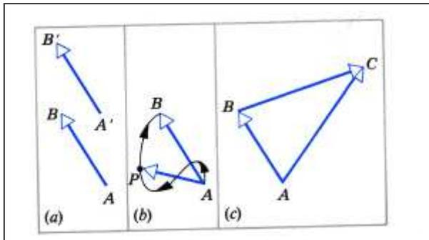
**Рис. 1.** Векторы смещений. (а) Векторы  $AB$  и  $A'B'$  идентичны, поскольку имеют одну и ту же длину и одно и то же направление. (б) Реальный путь частицы от  $A$  к  $B$  может быть криволинейным; *смещение* есть вектор  $AB$ . В промежуточной точке  $P$  смещение есть вектор  $AP$ ; (с) После смещения  $AB$  частица приобретает еще одно смещение  $BC$ . Результат двух смещений есть вектор  $AC$ .
