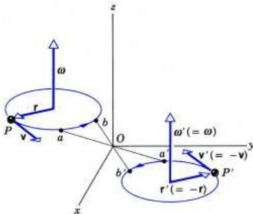
**Рис. 19.** Частица  $P$ , движущаяся по окружности, характеризуется вектором угловой скорости  $\boldsymbol{\omega}$ . Если все координаты отразить относительно начала координат  $O$ , то движение по окружности отраженной частицы  $P'$  характеризуется вектором угловой скорости  $\boldsymbol{\omega}'$ .
