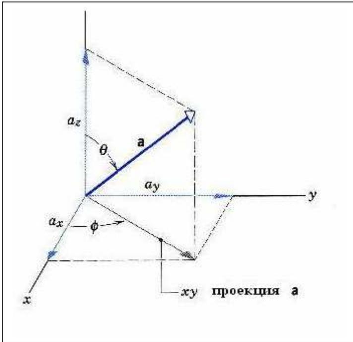
Рис. 7. Вектор  $\mathbf{a}$  в трех измерениях с компонентами  $a_x$ ,  $a_y$ ,  $a_z$ . Компоненты  $x$  и  $y$  находятся из проекции  $\mathbf{a}$  на плоскость  $xy$ . Угол  $\theta$  между  $\mathbf{a}$  и осью  $z$  называется *полярным углом*. Угол  $\phi$  между проекцией  $\mathbf{a}$  на плоскость  $xy$  и осью  $x$  называется *азимутальным углом*. Здесь азимутальный угол  $\phi$  имеет то же значение, что и на Рис. 6.
