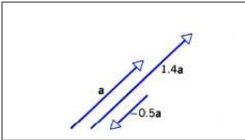
**Рис.15.** Умножение вектора  $\mathbf{a}$  на скаляр  $c$  дает вектор  $c\mathbf{a}$ , чье абсолютное значение в  $c$  раз больше абсолютного значения вектора  $\mathbf{a}$ . Вектор  $c\mathbf{a}$  имеет то же направление, что и вектор  $\mathbf{a}$ , если  $c>0$  и противоположное вектору  $\mathbf{a}$  направление, если  $c<0$ . Примеры на рисунке приведены для  $c=+1.4$  и  $c=-0.5$ .
