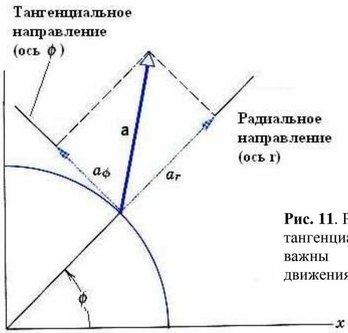
**Рис. 11.** Разложение вектора  $\mathbf{a}$  на радиальную и тангенциальную компоненты. Эти компоненты важны при изучении криволинейного движения.
