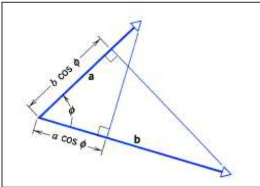
**Рис. 16.** Скалярное произведение  $\mathbf{a}\mathbf{b}=abc\cos\phi$  есть произведение абсолютной величины одного из векторов (например,  $a$ ) на проекцию второго вектора на направление первого ( $b\cos\phi$ ).
