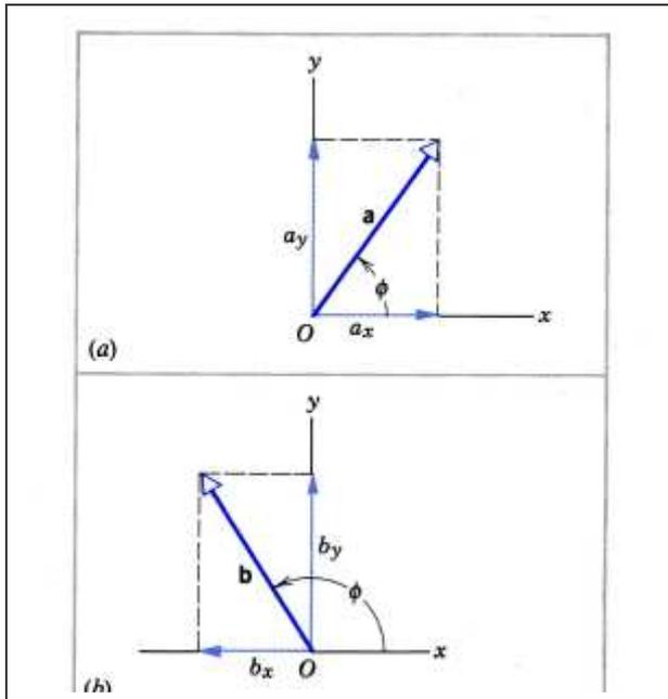
Рис. 6. (а) Вектор **a** имеет  $x$ - компоненту  $a_x$  и  $y$ -компоненту  $a_y$ . Вектор **b** имеет отрицательную  $x$  компоненту.
