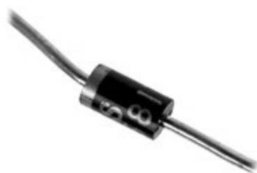
Рис. 6. Внешний вид ограничительного диода.
