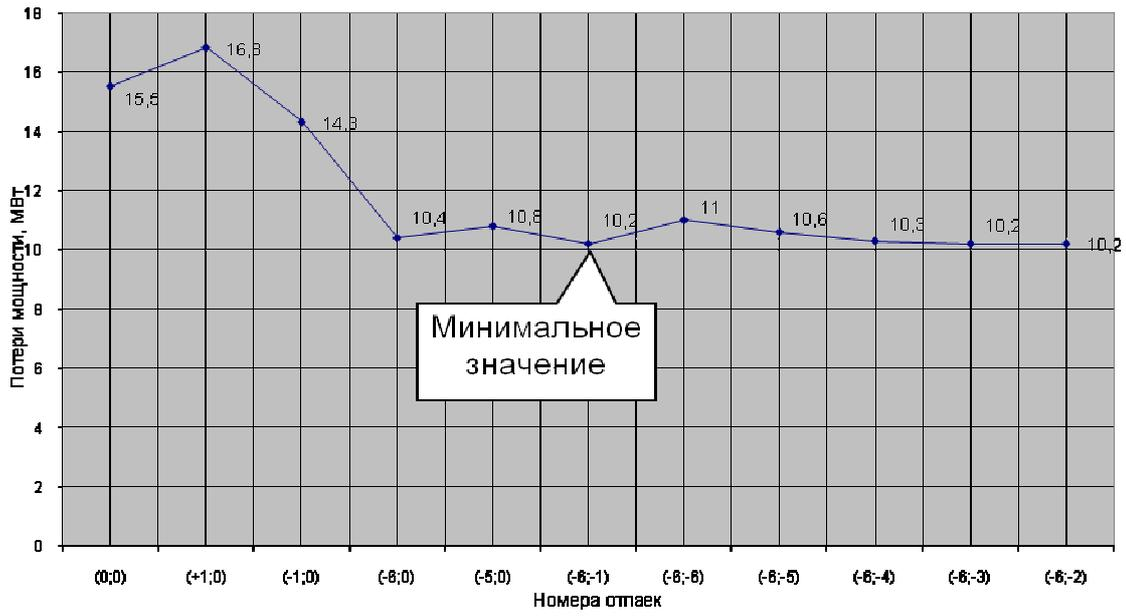
Рис.9. Диаграмма поиска оптимальных отпаяк трансформаторов Т1 и Т2
