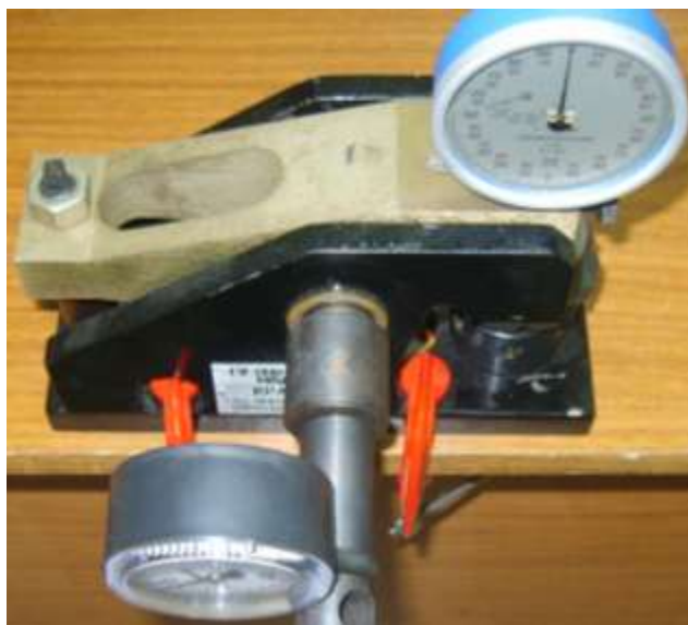
Рис. 43. Устройство определения относительной деформации клинка
