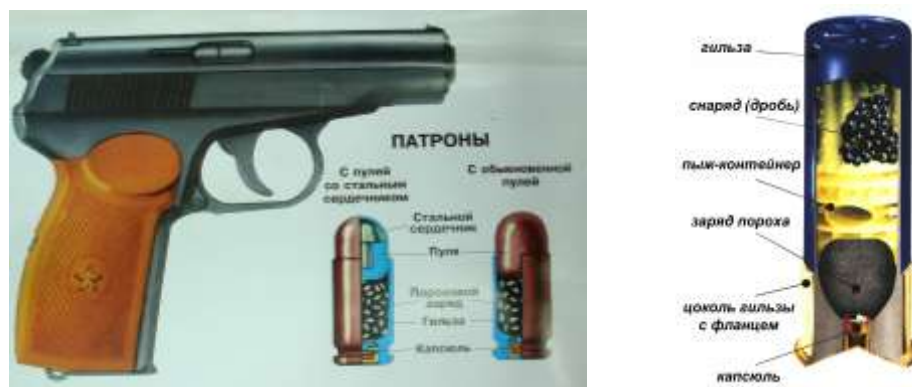
Рис. 46. Пистолет системы Макарова с патронами в разрезе
