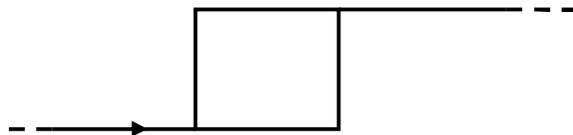
4. На рисунке приведена схема идеального электромагнитного рельсового ускорителя. Частица  $P$  разгоняется магнитным полем на длине рельсов  $L$ . Рельсы цилиндрические радиусом  $r$ . До какой максимальной скорости можно разогнать проводящую частицу массы  $m = 10 \text{ г}$ , если  $r = 6,7 \text{ см}$ ,  $b = 12 \text{ мм}$ ,  $L = 4 \text{ м}$ ,  $I = 450 \text{ кА}$ ?
