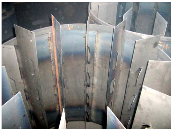
Рис. 7. Секции кожуха электрода рудно-термической электропечи
