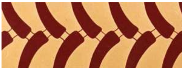
Рис. 4. Схематическая зарисовка беговой дорожки следов ТС в виде косонаправленных выступов, соединяющихся по центру
