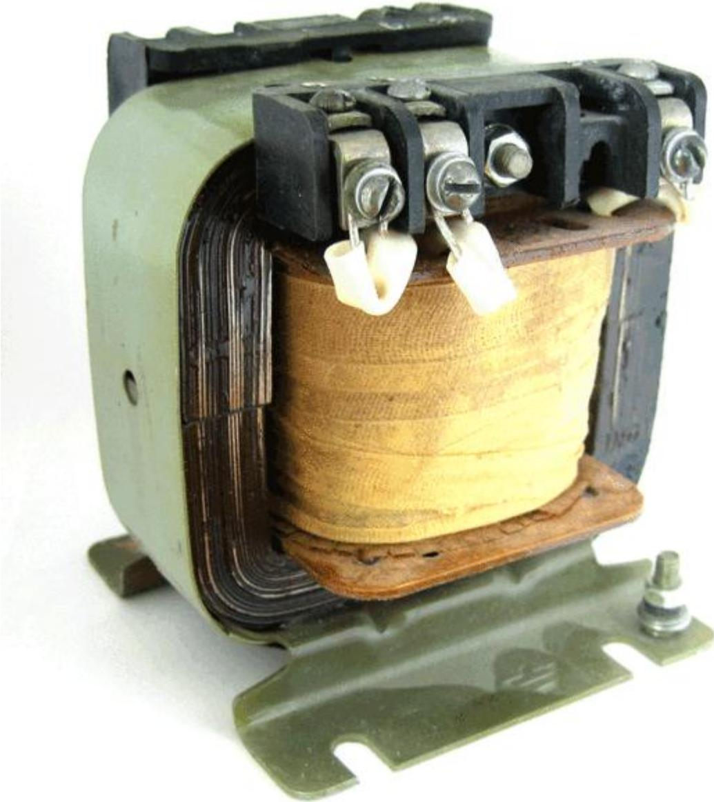
Рис. 4д. Трансформатор силовой ОСМ 0,16 - Однофазный сухой многоцелевого назначения мощностью 0.16 кВт, с ленточным магнитопроводом.
