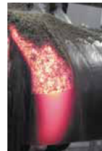
Дуговая наплавка под флюсом порошковой проволоки Corresist
