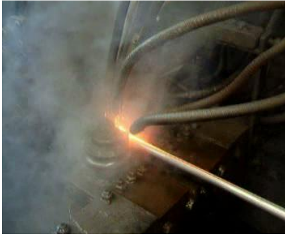
Изготовление трубы из ленты, заварка стыка высокочастотной сваркой
