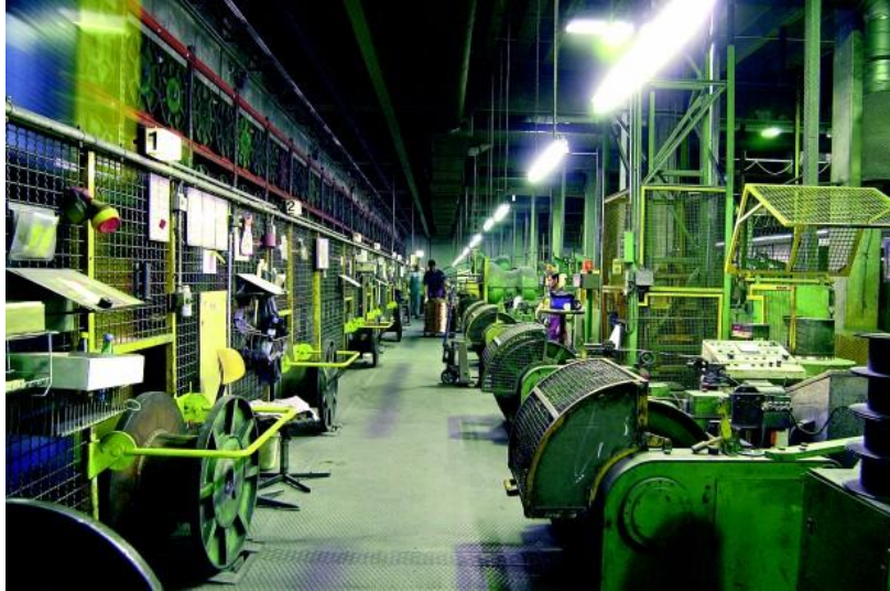
Волочение на конечный диаметр с омеднением поверхности
