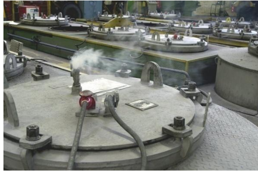
Рекристаллизация и калибровка на диаметр заполнения
