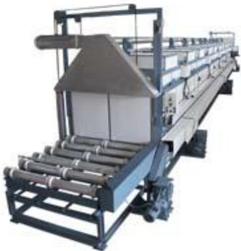
Нагрев печи с помощью специального калорифера, расположенного в верхней части печного модуля. Калорифер состоит из двух секций с нагревателями. Между секциями находится колесо центробежного вентилятора. Вентилятор обеспечивает продувку нагревателей воздушным потоком из рабочего пространства модуля. Нагретый воздух, от калорифера проходит по воздуховодам, расположенным вдоль боковых стенок туннеля, и через воздушные окна поступает под рольганг.
