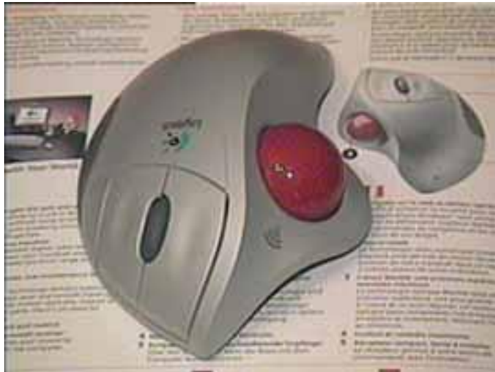
Рис. 8. Внешний вид манипулятора «Трекбол»
