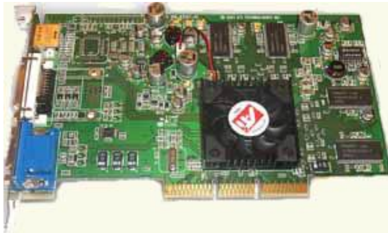
Рис.7. Внешний вид видеокарты
