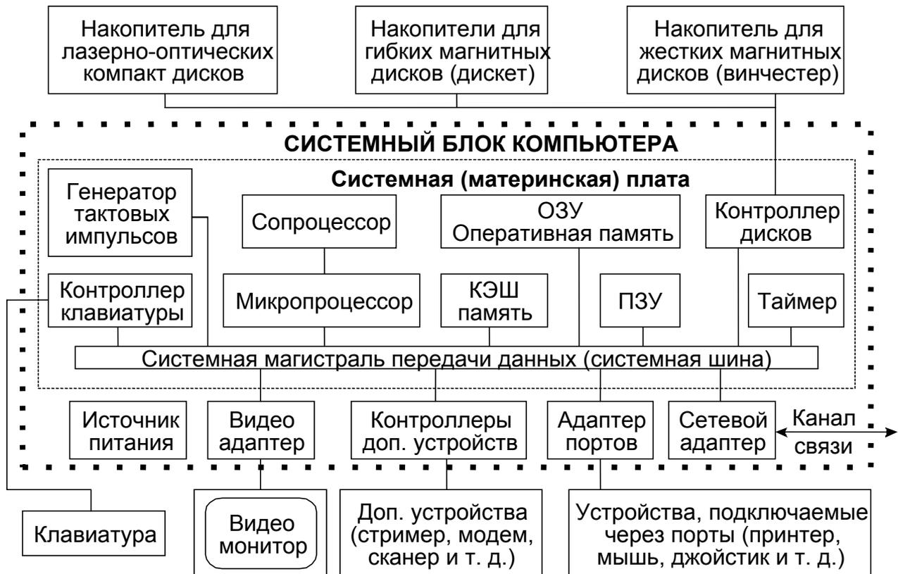
Рис. 6.3 Структурная схема персонального компьютера
