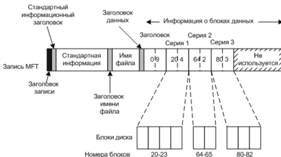
Рис. 3.3.Элемент MFT для файла, состоящего из трех сегментов
