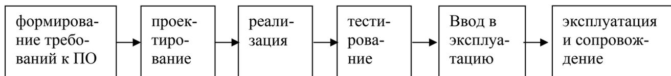
Рис. 4.1 Каскадная модель жизненного цикла ПО
