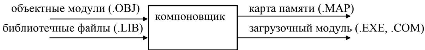
Рис. 4.3 Входные и выходные данные компоновщика
