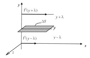
Пусть в направлении оси x течет жидкость, причем существует градиент скоростей направленного движения жидкости  $d\vec{V}/dy \neq 0$  вдоль оси y. Такой градиент скоростей можно осуществить в аква-
