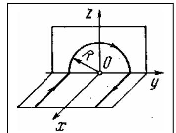
5. Найти величину и направление магнитного поля в точке О петли, по которой течет ток  $I = 1\text{ мА}$ . (см. Рис.)  $R = 10\text{ см}$ . Прямолинейные участки проводника очень длинные.
