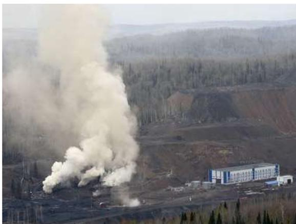
это распределение **угольной пыли** в воздухе **в концентрации**, способной **взрываться**
