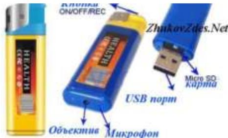
Рис. 15. USB камера в
