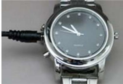
Рис. 5. Камера в часах
